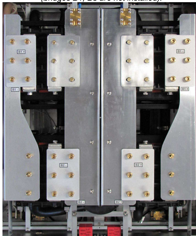
Abb. 8. Konfigurationsbeispiel für 2 x ( R_{int} = 25 \text{ m}\Omega ). Brücken B1, B2 sind eingesetzt. Brücken sind in jedem Pfad getrennt zu setzen.
