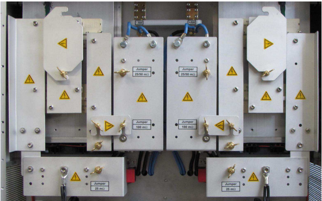
Abb. 4. Interne Widerstände sind in Konfiguration 2 x 100 mΩ. Fig. 4. Internal resistors are 2 x 100 mΩ in configuration.
