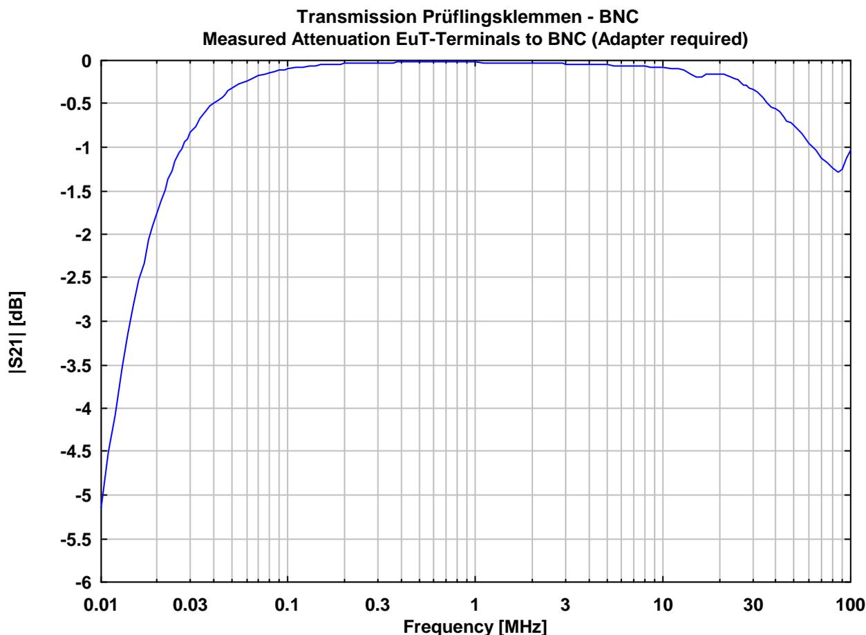
Abb. 4: Spannungsteilungsmaß Prüflingsklemmen - BNC (Spezialadapter erforderlich)
