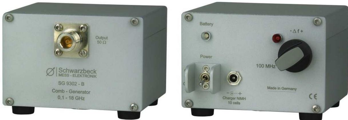
Der Kamm-Generator SG 9302 B erzeugt ein Linienspektrum im Frequenzbereich von 100 MHz bis 18 GHz. Zusammen mit einer Antenne kann er als Emissionsquelle zur Überprüfung von Freifeldern, Absorberkammern oder GTEM-Zellen eingesetzt werden. Natürlich können auch Einzelkomponenten wie Messempfänger, Spektrum-Analysatoren, Kabel, Dämpfungsglieder überwacht werden.
