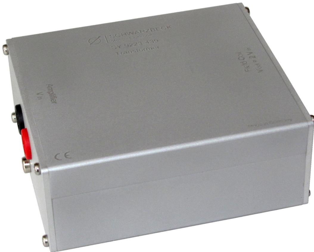
Der SY 9223-439 Übertrager bewirkt eine Spannungstransformation  $U_{in} / U_{out} = 1 / 2$  und ist für Betrieb mit handgeführten Feldspulen ausgelegt – z.B. FESP 5132 bei der Durchführung von Tests nach IEC 61000-4-39. Dafür muss die Feldspule mit der Signalspannung von über 60 Vrms bei 134 kHz gespeist werden um die Feldstärke von 65 A/m zu erreichen.
