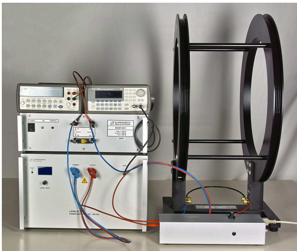
Abb. 5. Beispiel: Typischer Aufbau des Testsystems IMMSYS 85 kHz, bestehend aus Funktionsgenerator, Leistungsverstärker LFA 9733, Kompensationsnetzwerk NFCN 9732 85 kHz, Helmholtzspule HHS 5206-8, SHUNT 9571 und Voltmeter.
