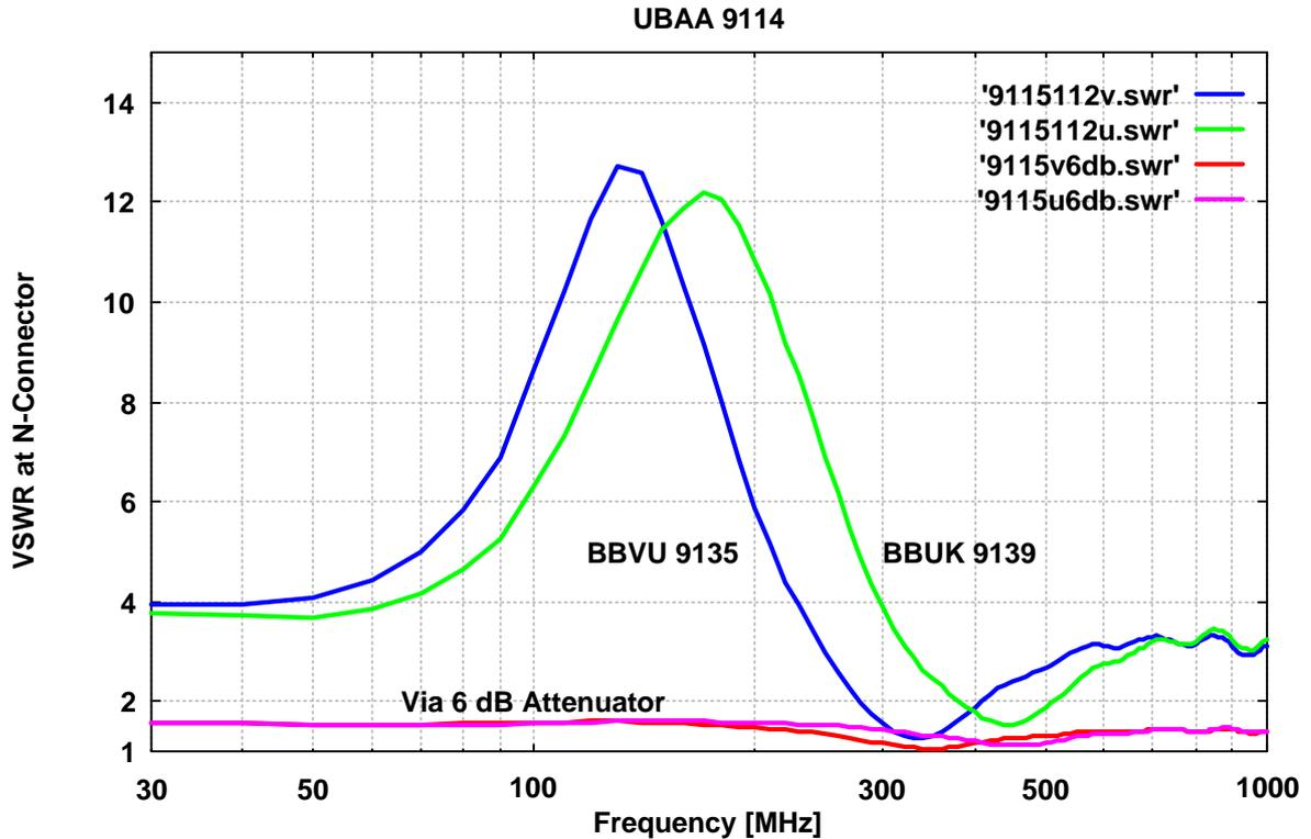
Zwischenschalten eines Dämpfungsgliedes ist zweckmäßig, wenn das angeschlossene Gerät ein hohes Eigen-SWR (z.B. in der 0 dB-Stellung des Eingangsteilers) aufweist. Dann ist diese Dämpfung zum Antennenwandlungsmaß zu addieren bzw. vom Gewinn abzuziehen. Bei Verwendung eines 6 dB-Dämpfungsgliedes kann über den gesamten Frequenzbereich gute Anpassung mit  $SWR < 2$  erreicht werden.
