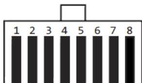
RJ-45/RJ-48/RJ-61 - 8P8C
