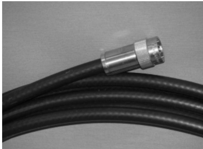
**AK 9513** ist im Frequenzbereich bis 3 GHz dämpfungsarm, flexibel und gleichzeitig sehr robust. Der Innenleiter besteht aus Kupferlitze ( $7 \times 0,75 \text{ mm}$ ). Der Durchmesser des Innenleiters beträgt  $2,25 \text{ mm}$ . Der Außenleiter besteht aus Kupfergeflecht. Das verlustarme Dielektrikum besteht aus Polyäthylen (PE).
