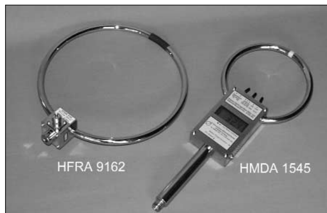
Abb. 1: Aktive und passive Rahmenantennen zur Messung der magneti- schen Feldstärke
