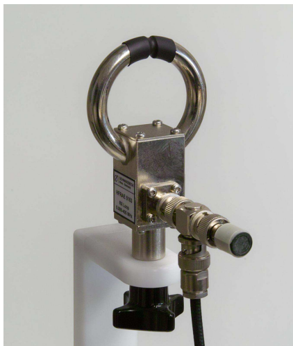
Abb.3 HFRAE 5163 Monitorantenne zur Kontrolle der magnetischen Feldstärke mit 1 Ohm Lastwiderstand Fig. 3: HFRAE 5163 Monitor loop to control magnetic field strength, terminated with 1 Ohm load.
